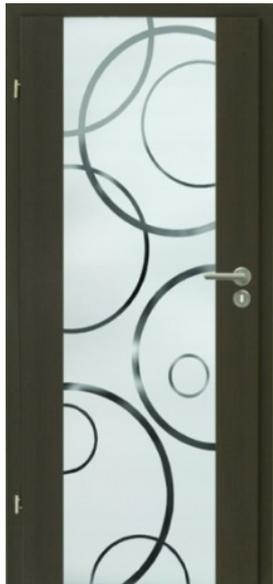
Дверное полотно включает в себя сотовый наполнитель. Каркас двери выполнен из сращенного по длине бруса, изготовленного из хвойных пород древесины или из панелей МДФ и обклеен декоративной пленкой. В комплект входит замочная планка и стойкий к износу уплотнитель. В комплект межкомнатной двери входит полотно, навесы, замок. Ручка подбирается заказчиком. Габариты двери: 2030 x 644 x 40 или 2030 x 744 x 40 или 2030 944 40. Возможна тонировка под черный дуб или орех.
